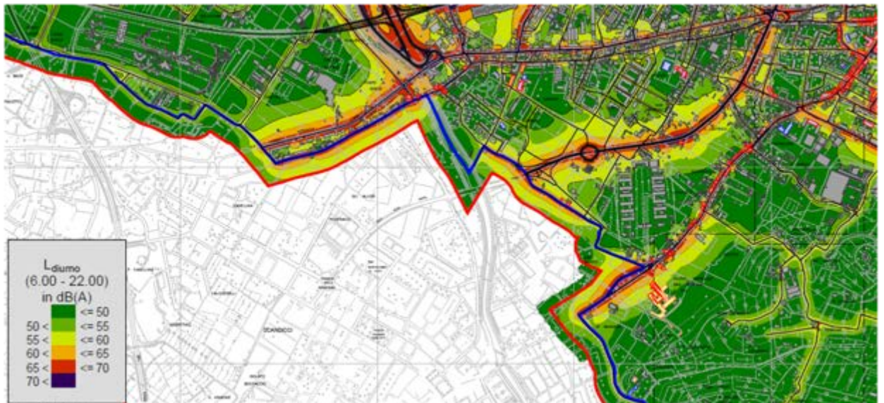
Aggiornamento del Piano d'Azione dell'Agglomerato di Firenze - Mappatura Acustica del rumore stradale (traffico veicolare + Linee ATAF + Linee GEST) - LDiurno (6.00-22.00) Tav. 8/8
